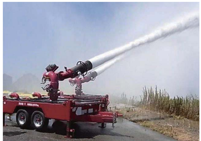
大容量泡放射システムによる放水訓練 (大阪・和歌山広域共同防災協議会)
